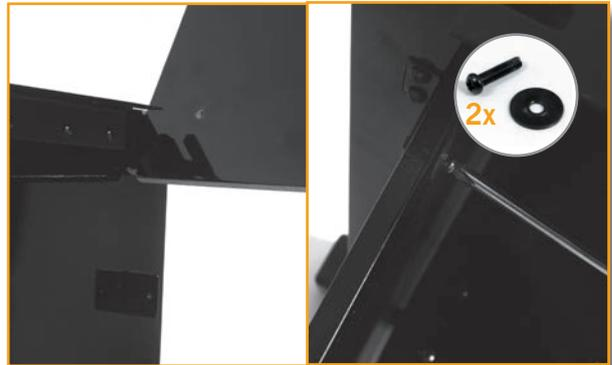
2 Schieben Sie die Rückwand vor den kleinen Winkelstücken ein und fixieren Sie beidseitig mit den beiden beigefügten Schrauben.
